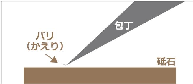
『バリ』とは刃先先端部分の金属が削れ、反対側に反り返った状態を指します。
