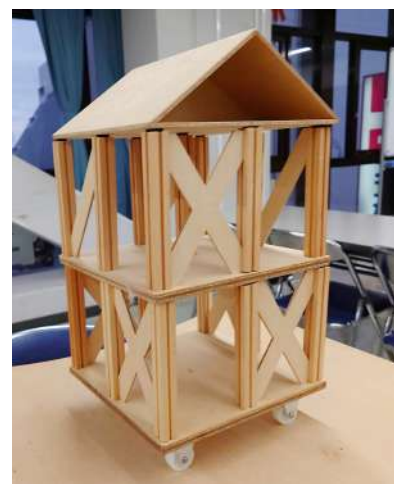
筋交いで補強した住宅模型
